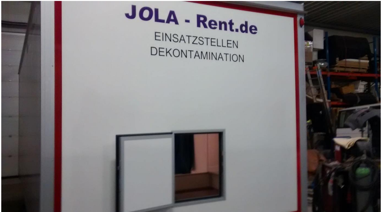
Abwurfschacht für kontaminierte Einsatzkleidung nach Aussen in Spezialbehälter
